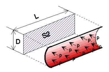
Ces deux forces créent des contraintes olet ot que l'on calcule en faisant des coupes fictives du tube par le plan longitudinal PL et le plan transversal PT.
